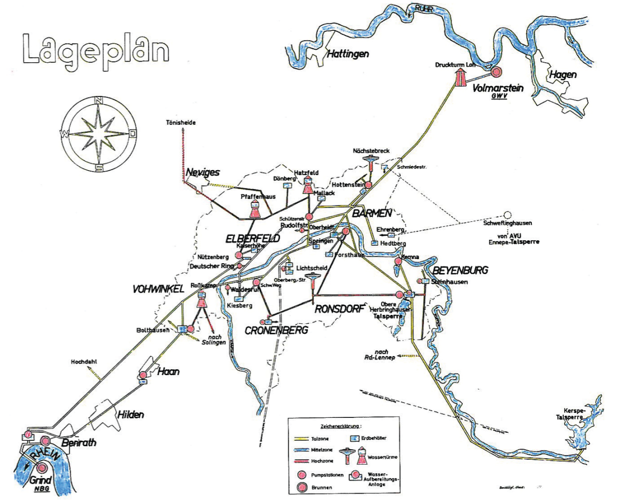
Abb. 3: Lageplan Wasserversorgung Wuppertal
